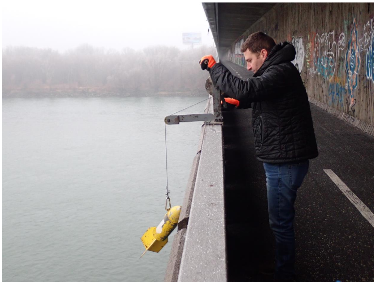
Obr.2.1 Integračné odbery vzoriek vody lapákom plavenín (VÚVH) – lokalita most Lafranconi
