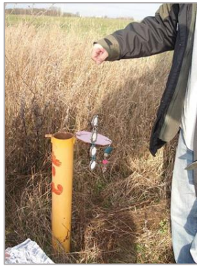
Obr. 5 Vzorkovač POCIS, aký sa používa pre extrakciu podzemných vôd a jeho inštalácia do vrtu.
