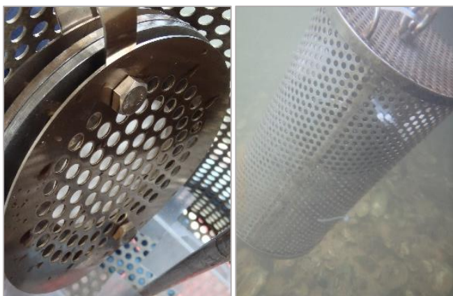
Obr. 7 Ochranný kryt pre vzorkovač POCIS a exponované vzorkovače v lokalite Váh/Komárno v r. 2018
