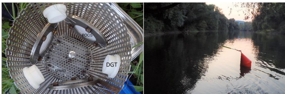
Obr. 6 Pasívne vzorkovače pred expozíciou v povrchovej vode v lokalite Chľaba (Ipeľ) inštalované v ochrannej klietke a zavesené zo stromu na bóji pomocou lana v roku 2016
