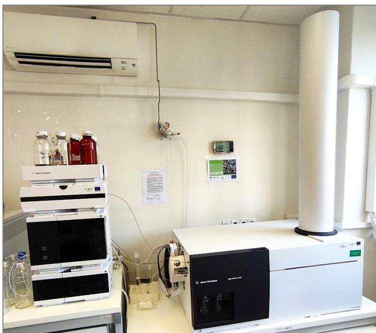
Obrázok 2.1.2.3.1. LC-MS zariadenie s 1290 Infinity II HPLC a 6545 Q-TOF využívané na kvalitatívne analýzy (skrining) polárnych organických znečisťujúcich látok vyskytujúcich sa vo vodnom prostredí.
