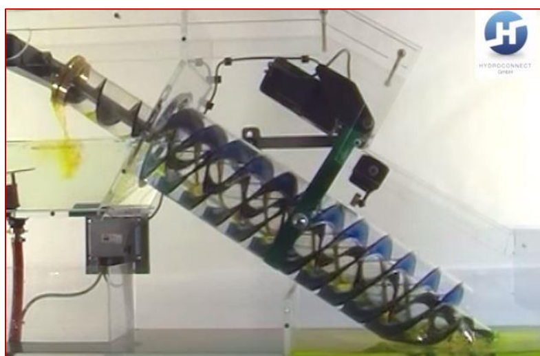
Obr. 164 Model dlhšieho vnútorného potrubia, vytlačajúceho vodu s rybami z dolnej hladiny do hornej, počas farbacej skúšky (žltá voda), a kratšieho vonkajšieho potrubia, zabezpečujúceho pohon a poprúdovú migráciu. (Hydro-Connect GmbH)
