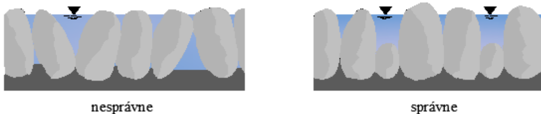
Obr. 201 Nesprávne a správne tvorenie štrbín (podľa DWA 2009 uvedené vo Fischaufstiegsanlagen in Bayern 2012).
