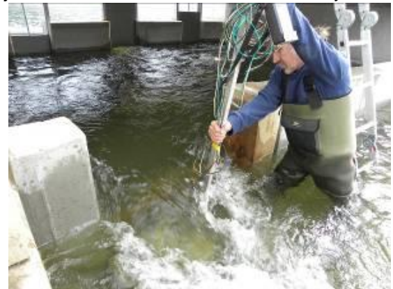
Obr. 213 Meranie rýchlostí v širokej štrbine.
