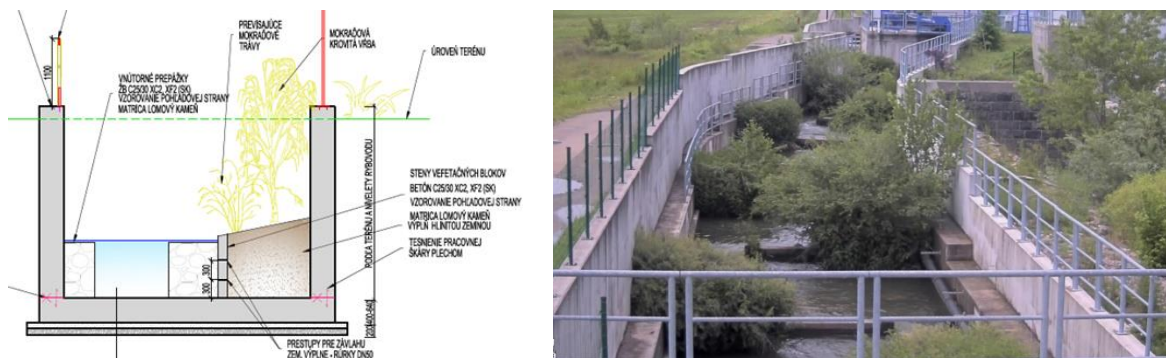
Obr. 33 a vľavo Príklad vegetačných zemných boxov v projekte (rybovod Zvolen) a Obr. 33 b vpravo Realizované zazemnené boxy v bazénovom rybovode Šalková po 6 rokoch prevádzky.
