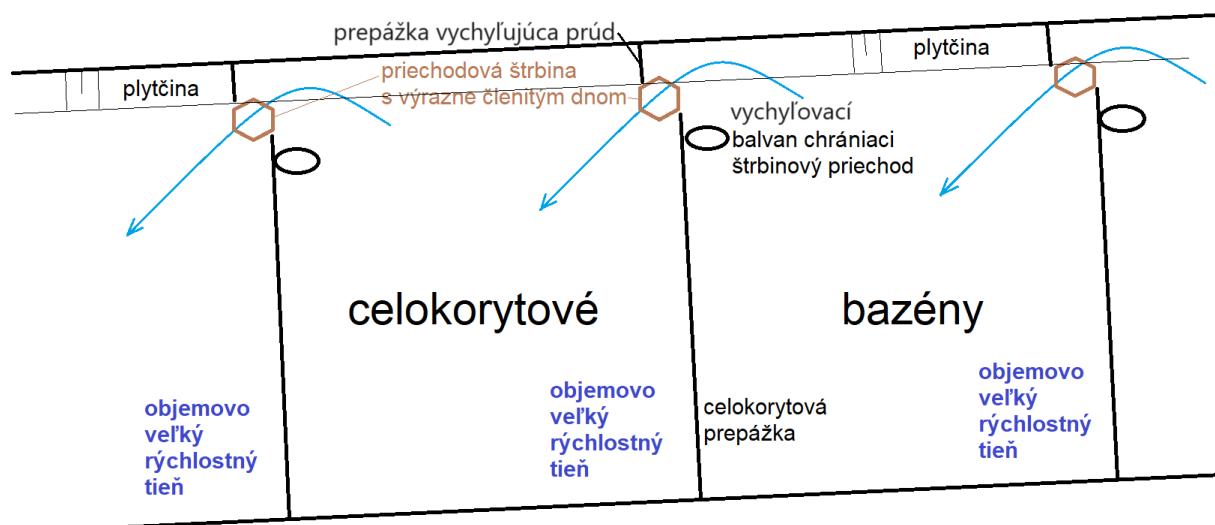
Obr. 24 Príklad riešenia celokorytových bazénov, ústretového pre drobné ryby a bentos.
