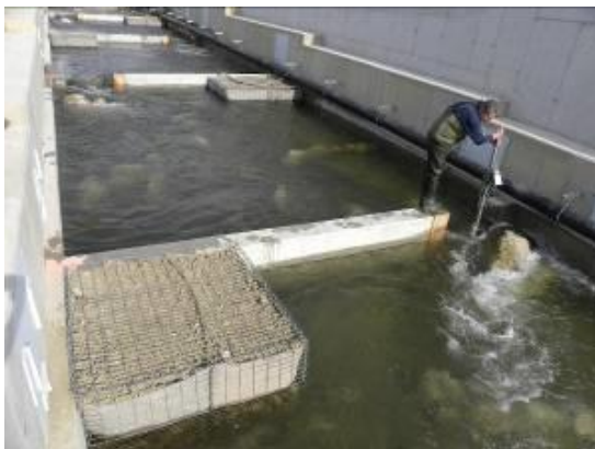
Obr. 214 Meranie rýchlostí v širokej štrbine.
