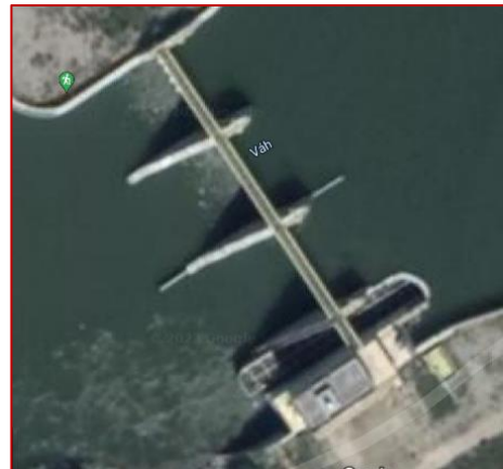
Obr. 169 rybovod medzi MVE a haťovými poľami MVE Trenčianske Biskupice II na Váhu) (zdroj ZBGIS)
