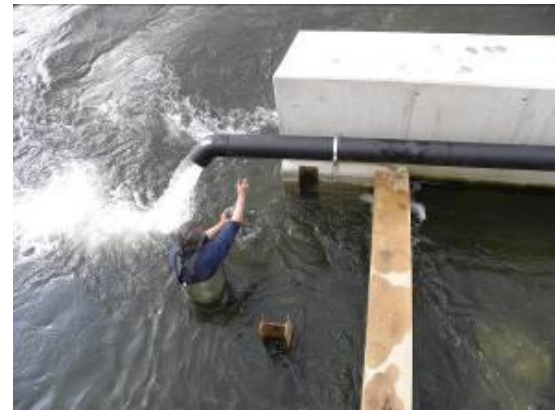
Obr. 215 Meranie rýchlostí na výtoku z rybovodu (lákový prúd na vstupe do rybovodu).
