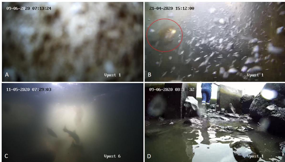
Obr. 219: A – nárazy na kamere znemožňujúce identifikáciu, B – spenená voda znemožňujúca identifikáciu, C – orientácia kamier proti svetlu znemožňujúca identifikáciu, D – technická údržba, ktorá na istý čas znefunkční objekt rybovodu (Andreji, 2022).
