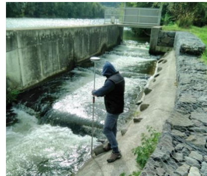
Obr. 211 Zameranie hladiny GPS.
