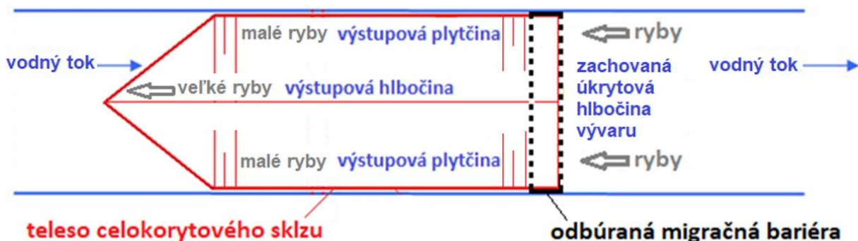
Obr. 1 Pôdorys celokorytového bezprepážkového sklzu, priečne preliačeného.
