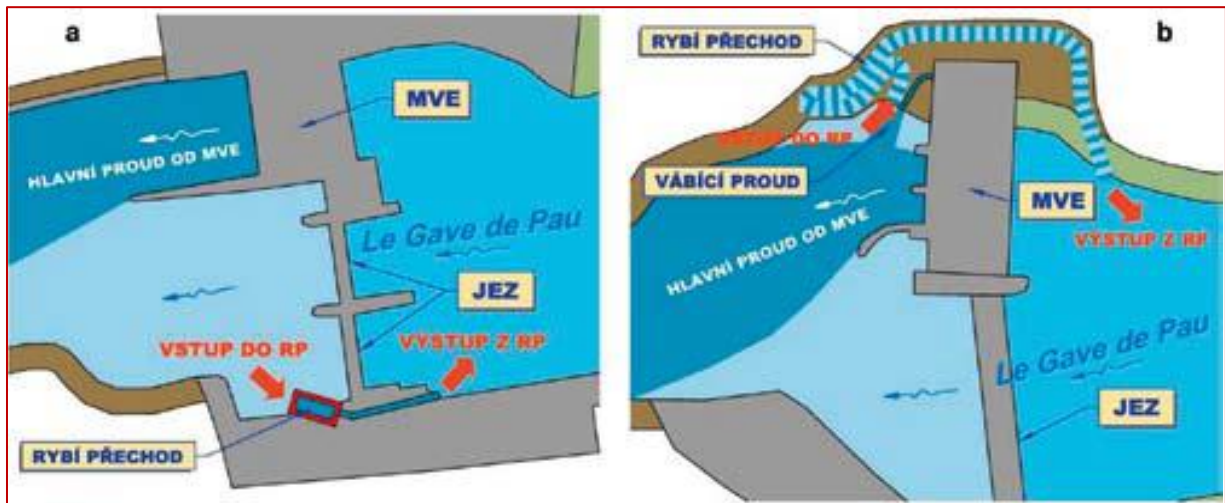
Obr. 166 a (vľavo) – príklad nevhodného umiestnenia rybovodu, Obr. 166 b (vpravo) – príklad vhodného umiestnenia rybovodu (Larinier 2005, upravené podľa Slávik et al. 2012).
