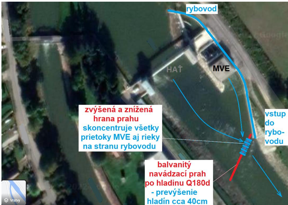
Obr. 17 Príklad umiestnenia navádzacieho prahu pre navedenie rýb a koncentráciu prítoku z MVE a z rieky na polovicu priľahlú k rybovodu (zdroj ZBGIS).
