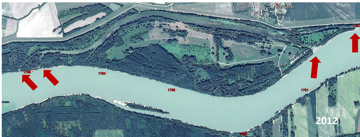
Obr. D.10 Velkolélský ostrov – stav pred otvorením ramien – všetky ramená boli oddelené od koryta na úrovni výšky brehovej línie
