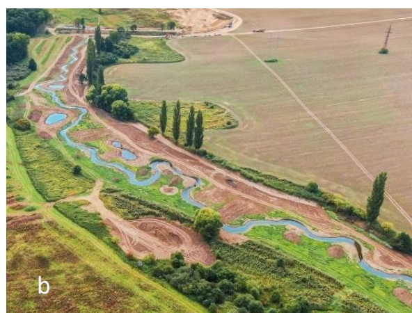
Obr.C.7 Príklady premeandrovania napriamenej uprevneného koryta s priestorovým obmedzením a) rieka Skerne v urbanizovanom priestore, Anglicko, b) rieka v poľnohospodársky využívannej krajine-Česká republika
