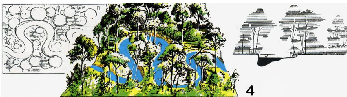
Obr.8.1 Schéma postupného vývoja rieky od napriameného k prirodzenému riečnemu korytu (meandrujúceho typu) po odstránení brehového opevnenia a uvoľnení laterálneho vývoja (Binder et al, 2015)
