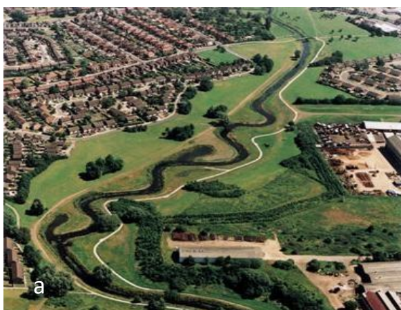
Obr.C.7 Príklady premeandrovania napriamenej uprevneného koryta s priestorovým obmedzením a) rieka Skerne v urbanizovanom priestore, Anglicko, b) rieka v poľnohospodársky využívannej krajine-Česká republika
