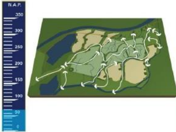
40-70cm +NAP: reguliere getijdesslag, water stroomt via de kreeken in en uit.
