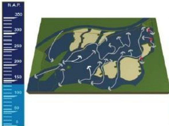
135cm +NAP: laag bekade landbouwpolders stromen onder water. Schotbalken in de Steurgatbruggen worden geplaatst op 1 oktober.
