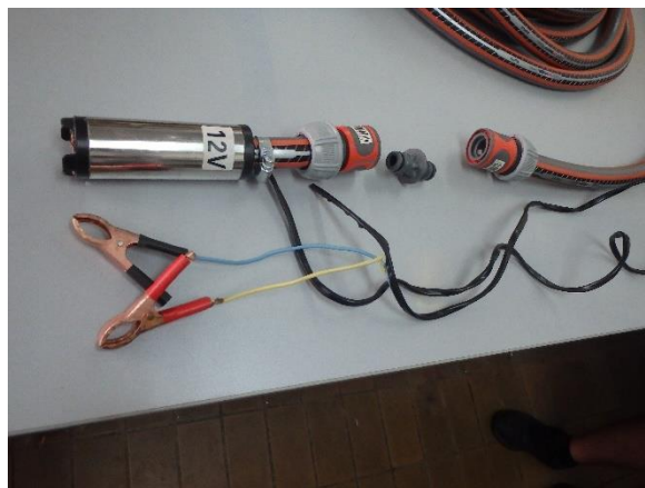
Obr. 6: Čerpadlo na prepláchnutie hadice po odbere prepojené s rýchlo-spojku
