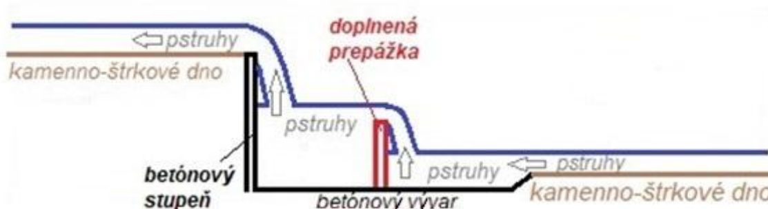
Obr. 7 Pozdĺžny rez vodopádovým spriechodnením vhodným len pre pstruhy.
