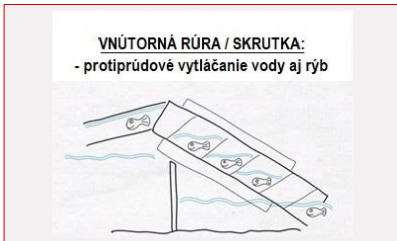
Obr. 163 Schéma vnútorného potrubia pre vytláčanie vody a rýb z dolnej vody nahor. (Hydro-Connect GmbH)
