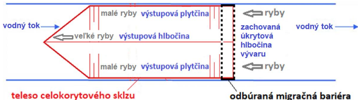
Obr. 1 Pôdorys celokorytového bezprepážkového sklzu, priečne preliačeného.
