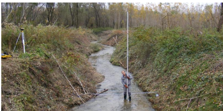
Obr. 210 Nivelácia profilu pomocou nivelačného prístroja.
