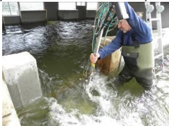
Obr. 213 Meranie rýchlostí v širokej štrbine.
