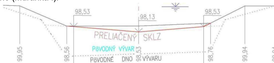
Obr. 51 Priečný rez v mieste pôvodného 1-metrového stupňa bol tento plynule odbúraný až o niekoľko desiatok centimetrov v jeho strednej časti.
