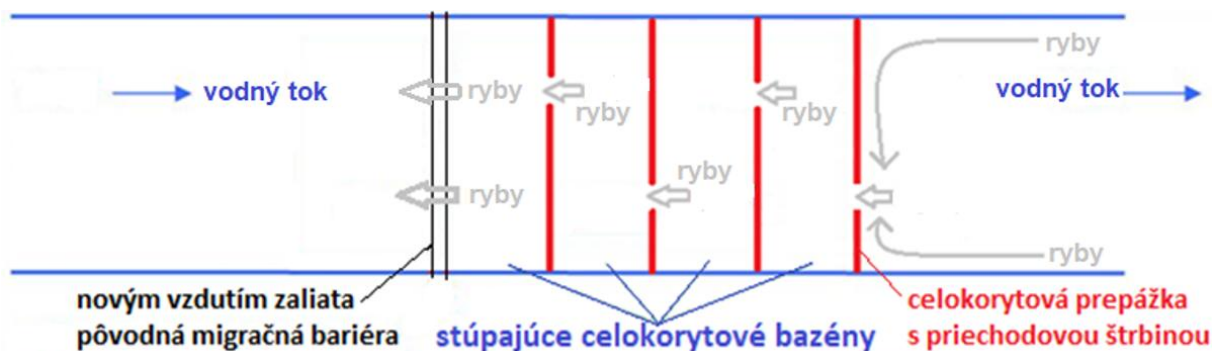
Obr. 2 Pôdorys celokorytových bazénov (s prepážkami prerušenými širokou štrbinou).
