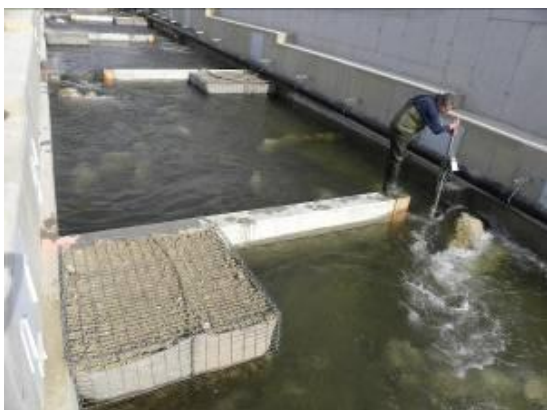
Obr. 214 Meranie rýchlostí v širokej štrbine.
