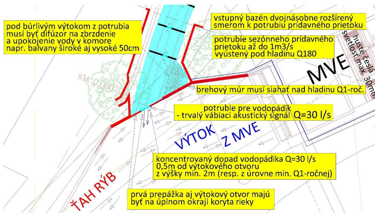
Obr. 172 Príklad riešenia koncentrácie vábiacich signálov: vstup do rybovodu tesne pod VE, vábiac výtokový prúd koncentrovaný priamo do hlavného toku, akustický signál vodopádika, zaústenie a upokojenie sezónneho prídavného prietoku do dolnej rozšírenej komory, ochrana pred deštrukčnými povodňami.
